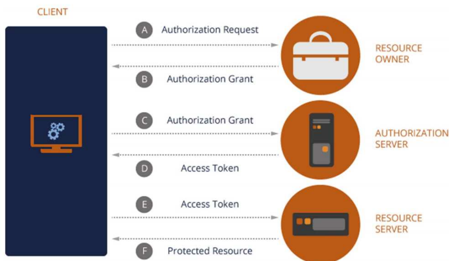
Рис. 2. Абстрактная схема авторизации клиента в протоколе OAuth
