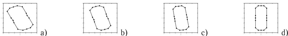
Рис. 3. Результат диффеоморфного отображения исходного изображения до терминального изображения: а) исходное изображение  $t = 0$ ; б) преобразование при  $t = 0,4$ ; в) преобразование при  $t = 0,7$ ; д) терминальное изображение
