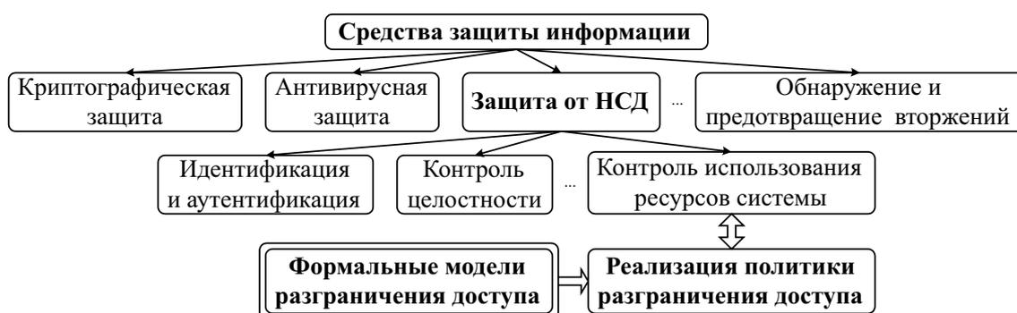
Рис. 1. Место формальных моделей разграничения доступа в системе комплексной защиты информации
