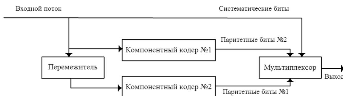
Рис. 2. Схема турбо-кодера
