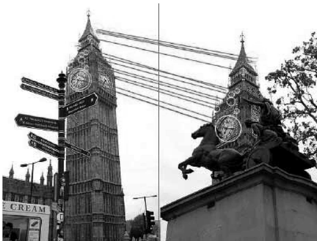
Рис. 1. Показаны особые точки изображения в образце (слева) и на сцене (справа). Несмотря на то, что сцена имеет другой масштаб, угол обзора и частично заслонена другим объектом, ключевые точки достаточно точно идентифицируются
